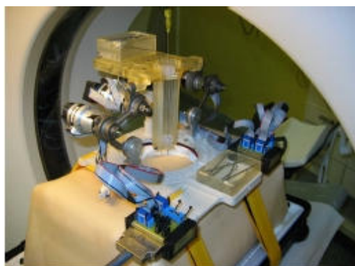
Photo 2: assistant robotique pour les interventions percutanées sous scanner (LSIIT-IRCAD-HUS).
